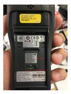
12- Deslizar a tampa para cima, conforme a especificação da seta mostrada na tampa. Após isso remover o SD Card e colocar o mesmo em uma leitora de SD Card.
